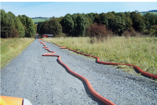
Abb. 156: Eine ungeschickt verlegte Leitung kann einen Weg für Großfahrzeuge unbrauchbar machen. Leitungen gehören an den Wegesrand! Großvolumige Leitungen können nach dem Verlegen (i.d.R. aus dem fahrenden Fahrzeug) nicht mehr so einfach manuell verlegt werden (gefüllt ggf. gar nicht mehr), vgl. Abb. 155. (Foto: Bräutigam)
