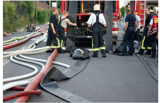
Abb. 155: Wird besonders viel Löschwasser an einer Stelle benötigt, so sind ggf. besondere Förderleitungen (z.B. „F“ oder noch größer) mit leistungsfähigen Pumpen (FLB; „HFS“ o.ä.) zu verwenden. (Foto: Nottebrock, Neuss)
