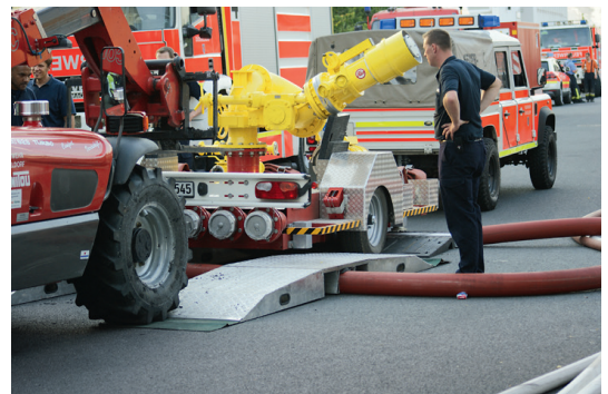
Abb. 157: Nachträglich verlegte Schlauchbrücken für die Größe „F“ oder größer sind aufgrund der zum Überqueren nötigen Rampen- bzw. Überhangwinkel bzw. wegen der erforderlichen Bodenfreiheit für viele Fahrzeuge bereits unüberwindliche Hindernisse. Hier muss ein FwA mit einem Großwerfer mittels Teleskopklader über die Schlauchbrücke gehoben werden. (Bahnstrecken müssen dann ggf. gesperrt werden!) (Foto: Nottebrock, Neuss)
