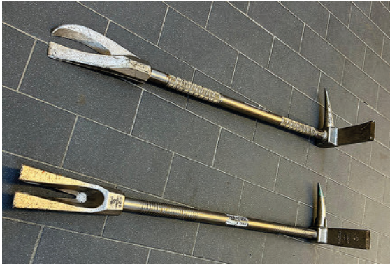
Bild 1: Halligan-Tool mit Metallschneidklaue (oben) und Halligan-Tool mit Hebelklaue (unten)
