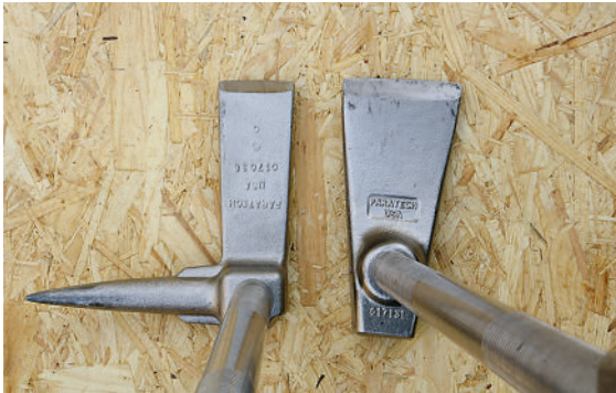
Bild 2: Halligan-Tool (links) und Kelly-Tool (rechts) (Quelle: Irakli West)
