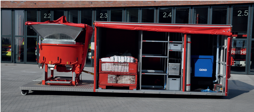
Abbildung 45: Sandsackfüllmaschinen gibt es auch eingebaut in Abrollbehälter, diese sind noch schneller aufgebaut und können mit dem mitgeführten Material (leere Säcke usw.) mit zugeliefertem Sand sofort betrieben werden. Hier die Ausführung der Feuerwehr Ratingen (Quelle: Dirk Wieczorek, Ratingen)
