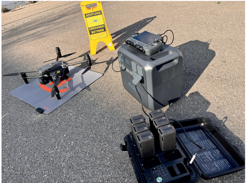
Abb. 59: Ladung mehrerer Akkus einer DJI-M30T an einem mobilen Batteriesystem (Quelle: Nico Ninov)
