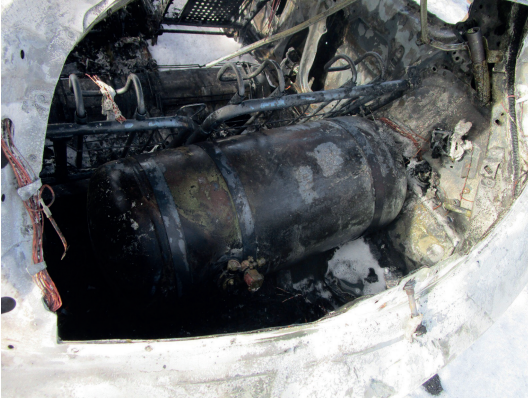
Abb. 143: Fahrzeugbrand mit Flüssiggastank. (Quelle: Löschzug Haaren)
