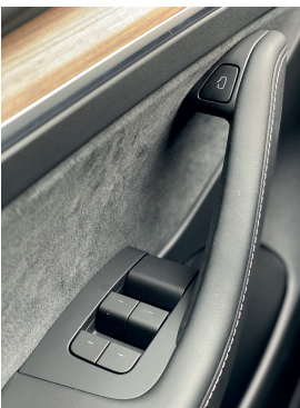
Abb. 138: elektrische Türöffnung (oberste Taste) eines TESLA Model 3. (Quelle: Tanja Hellmann)
