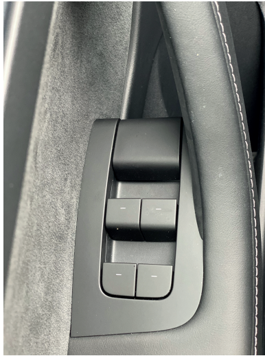
Abb. 139: Notentriegelung, mechanische Öffnung der Tür (oberster Hebel) TESLA Model 3. (Quelle: Tanja Hellmann)
