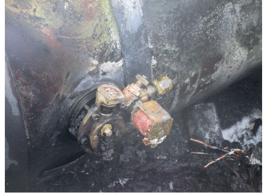
Abb. 144: Multiventil nach Flammenbeaufschlagung. (Quellen: Löschzug Haaren)
